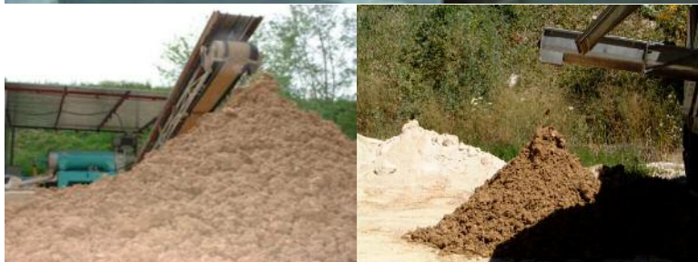
Boue déshydratée : pas de ressurgement d'eau, siccité élevée
